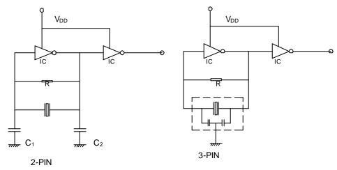
IC: TC74HCU04  $V_{DD}$ :  $+5V\pm0.1V$  R:  $1M\Omega$   $C_1$ ,  $C_2$ : 30PF
