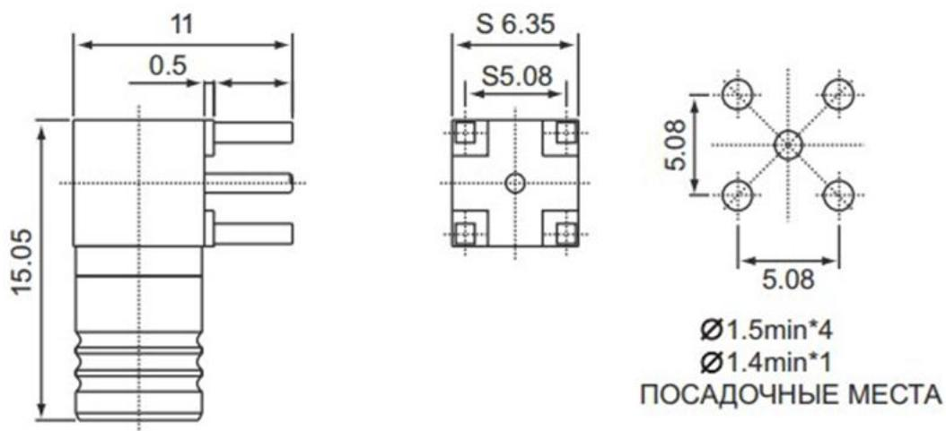
Разъем имеет позолоченный центральный проводник и позолоченный корпус. Изолятор, как правило, изготовлен из фторопластика.
