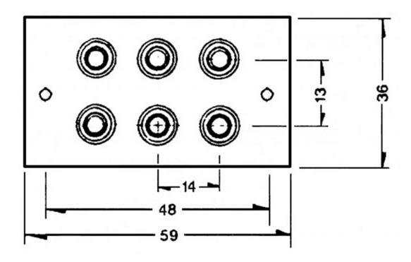
Панель предназначена для ввода-вывода аудио сигналов в различной аппаратуре. Реже используется для вводавывода видеосигналов.
