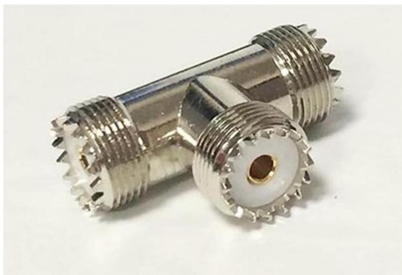
**Переходник предназначен для стыковки кабелей и приборов, имеющих соответствующие ответные части ВЧ разъемов стандартов UHF. Переходник имеет позолоченный центральный проводник и хромированный корпус. Необходимо помнить, что наименьшие потери сигнала и лучшее согласование, достигается при подключении одного потребителя (одной нагрузки) к источнику сигнала. При подключении двух (и более) нагрузок, для предотвращения потери сигнала, необходимо применять цепи согласования.**
