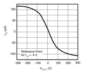
Figure 10-9. Load Limit Control
