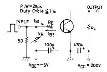
Unit (resistance :  $\Omega$ , capacitance : F)
