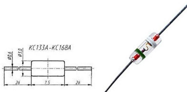
Стабилитрон KC139A кремниевый, сплавный, малой мощности.
