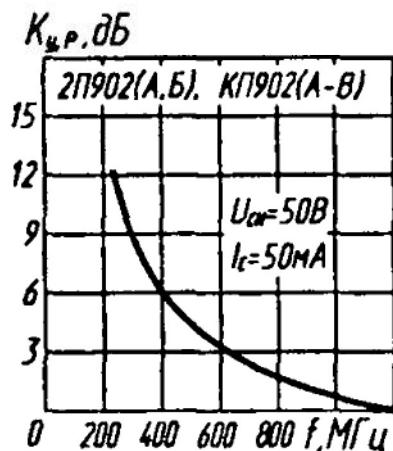
Зависимость коэффициента усиления по мощности от частоты
