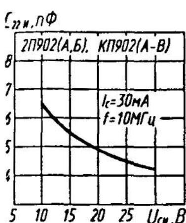
Зависимость выходной ёмкости от напряжения сток—исток
