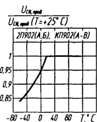
Зависимость относительного пробивного напряжения сток—исток от температуры
