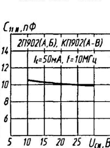
Зависимость входной ёмкости от напряжения сток—исток
