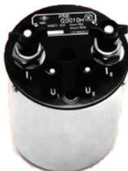
**Катушки электрического сопротивления измерительные Р331** предназначены для использования в качестве образцовых мер электрического сопротивления для поверки и подбора резисторов в цепях постоянного тока, рабочих катушек сопротивления, а также поверки электроизмерительных приборов в потенциометрических и мостовых схемах постоянного тока. Элементы сопротивления измерительных катушек изготовлены из манганина. Корпуса катушек металлические.
