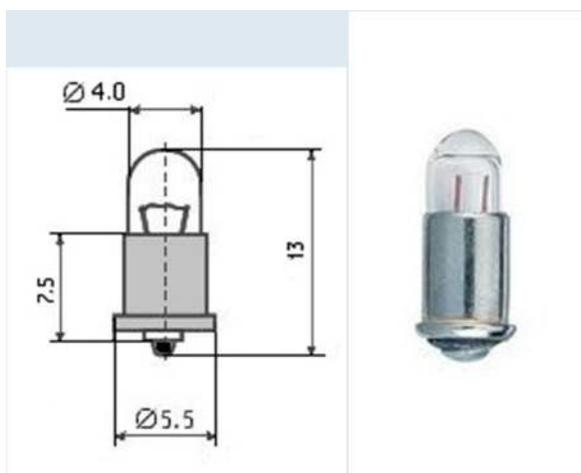
Миниатюрная лампа накаливания применяется для освещения и подсветки шкал радиоэлектронных приборов, сигнализации, в карманных, портативных и батарейных фонарях
