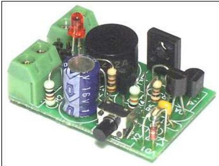
Предлагаемый набор позволит радиолюбителю собрать простой и надежный звуковой оповещатель. Устройство представляет собой синтезатор запрограммированной мелодии со встроенным усилителем мощности ( $P_{\text{вых.макс}} = 5 \text{ Вт}$ ).
