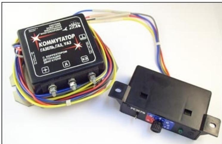
Данный модуль предназначен для владельцев автомобилей "ГАЗ", "УАЗ и др., имеющих индукционные датчики в распределителе зажигания.
