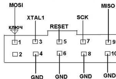
Рис.3 Сигналы на разъеме шлейфа
