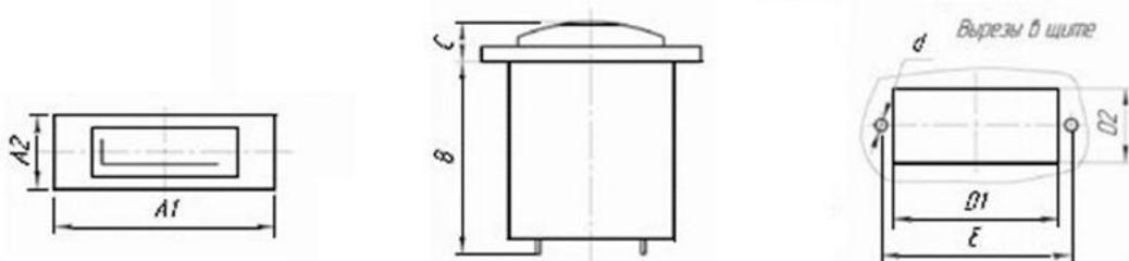
A1 - 52мм, A2 - 20мм, B - 41мм, C - 12мм, D1 – 40,5мм, D2 – 21мм, d – 3,4мм, E – 46мм.
