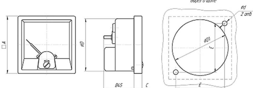
где А - 60мм, В - 35мм, С - 11мм, Д - 54,6мм, Д1 - 57,5мм, д - 3,4мм, Е - 50мм;
