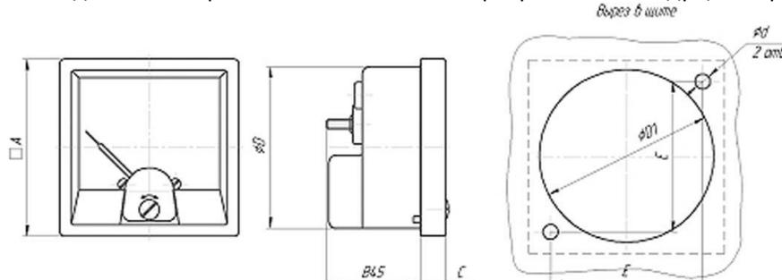
где A - 60мм, B - 35мм, C - 11мм, D - 54,6мм, D1 - 57,5мм, d - 3,4мм, E - 50мм;
