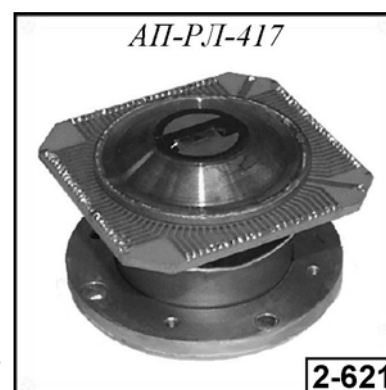
Рис. 2.4.30. Внешний вид многоэлементного охлаждаемого фоторезистора АП-РЛ-417
