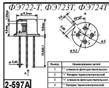
Рис. 2.4.13. Внешний вид, габаритные размеры и относительная спектральная характеристика гальванических элементов серий ФЭ722Т, ФЭ723Т, ФЭ724Т
