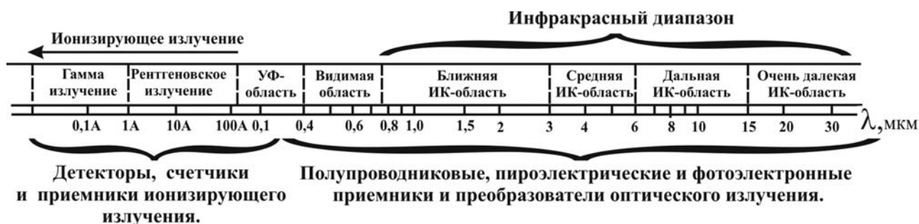
Рис. В1. Условное деление электромагнитного спектра на диапазоны
