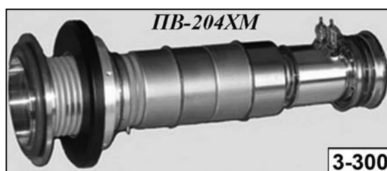
Рис. 3.6.34. Внешний вид рентгеновского преобразователя ПВ-204ХМ
