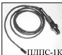
Рис. 1.57. Внешний вид и габаритные размеры детектора ПДПС-1К
