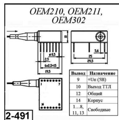
Рис. 2.3.122. Внешний вид и габаритные размеры и модулей серий OEM210-х, OEM302
