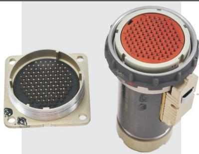
Соединители предназначены для работы в электрических цепях постоянного, переменного (частотой до 3 МГц) и импульсного токов при напряжении до 200 В (амплитудное значение).
