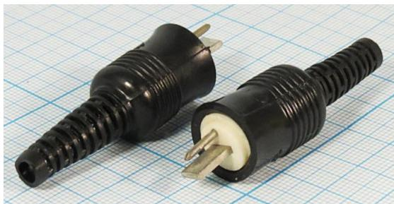
DIN-разъём для акустических систем, называемый также «точка-тире». Поляризованный двухконтактный неэкранированный разъём, разработанный для подключения громкоговорителя к усилителю мощности звуковой частоты или другому устройству. Он существует в виде гнезда для монтажа на панель. Гнезда или штекера на кабель. Круглый контакт подключается к положительному полюсу (красный), а плоский — к отрицательному (чёрный).
