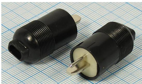
DIN-разъём для акустических систем, называемый также «точка-тире». Поляризованный двухконтактный неэкранированный разъём, разработанный для подключения громкоговорителя к усилителю мощности звуковой частоты или другому устройству. Он существует в виде гнезда для монтажа на панель. Гнезда или штекера на кабель. Круглый контакт подключается к положительному полюсу (красный), а плоский — к отрицательному (чёрный).
