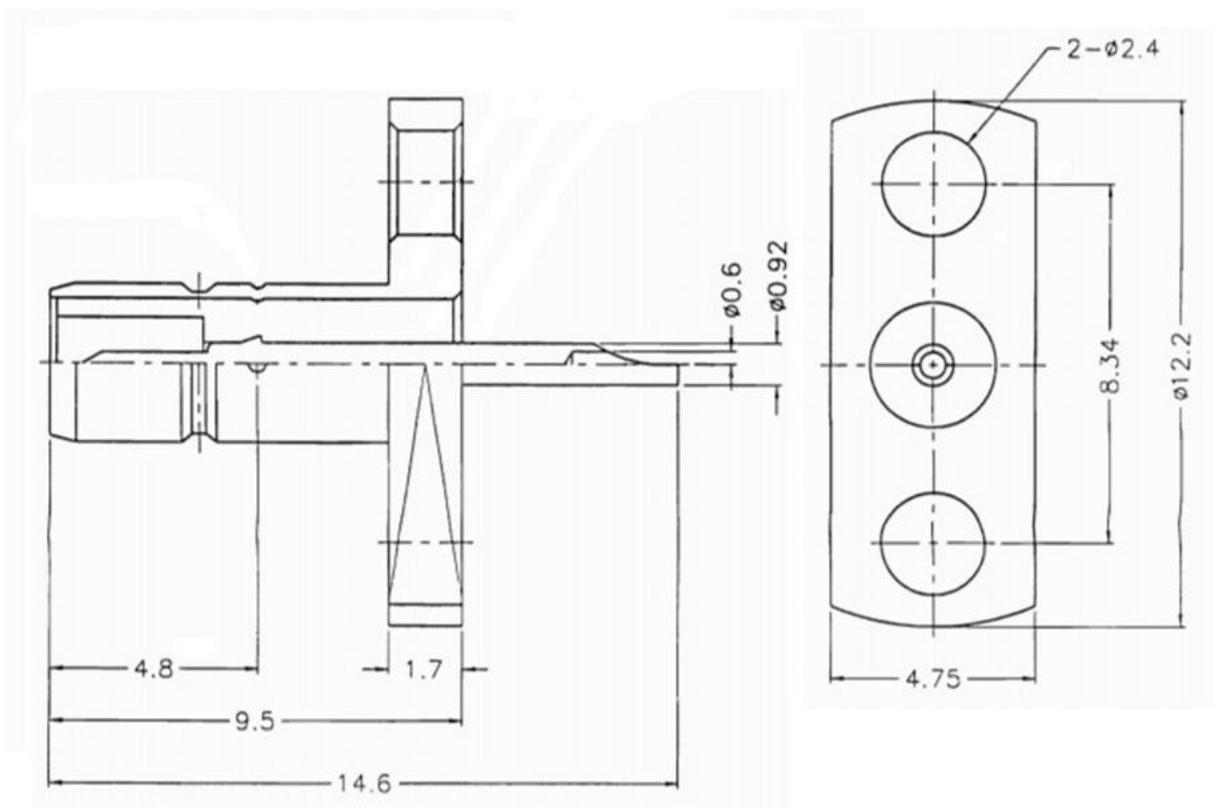
Гнездо имеет позолоченный центральный проводник и позолоченный корпус. Изолятор, как правило, изготовлен из фторопласта.
