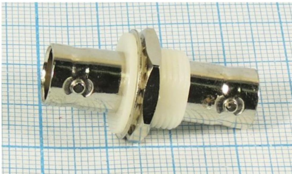
**Переходник предназначен для стыковки кабелей и приборов, имеющих соответствующие ответные части ВЧ разъемов стандарта BNC. Переходник имеет никелированный центральный проводник и хромированный корпус. При монтаже на приборную панель, контакты разъема гальванически изолированы от материала панели.**
