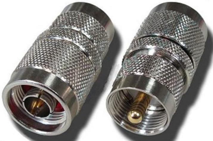
**Переходник предназначен длястыковки кабелей и приборов, имеющих соответствующие ответные части ВЧ разъемов стандарта N-типа и UHF. Переходник имеет позолоченный центральный проводник и хромированный корпус. Изолятор изготовлен из фторопласта или из бакелита.**
