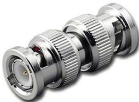
**Переходник предназначен для стыковки кабелей и приборов, имеющих соответствующие ответные части ВЧ разъемов стандарта BNC. Переходник имеет позолоченный центральный проводник и хромированный корпус. Пятидесятиомные версии разъемов работают на частотах до 11 ГГц.**
