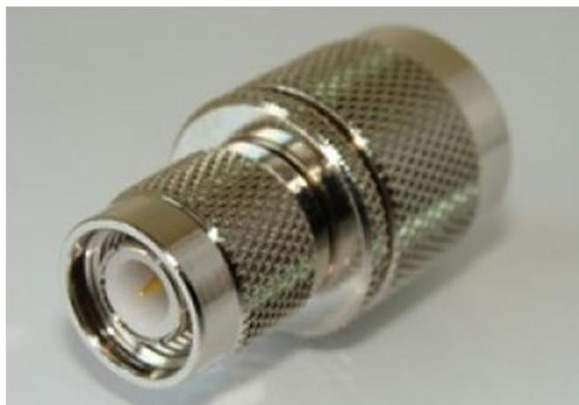
**Переходник предназначен для стыковки кабелей и приборов, имеющих соответствующие ответные части ВЧ разъемов стандарта N-типа и TNC. Переходник имеет позолоченный центральный проводник и хромированный корпус. Изолятор изготовлен из фторопласта или из бакелита.**
