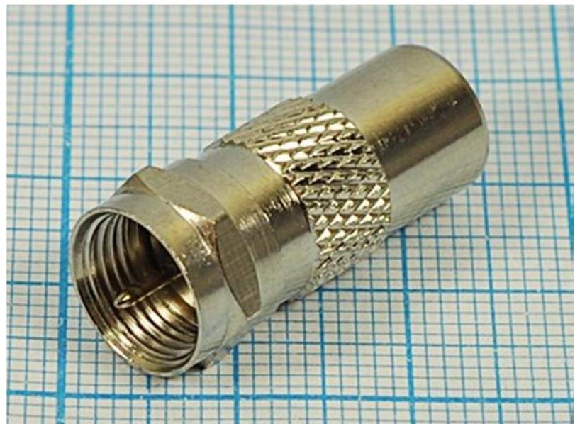
**Переходник имеет никелированный центральный контакт и никелированный корпус. Изолятор изготовлен из фторопласта (полиэтилена, полистирола). Назначение переходника – сопряжение TV разъемов с кабелями и устройствами имеющими разъемы стандарта F.**
