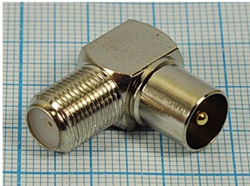
**Переходник имеет позолоченный центральный контакт и никелированный корпус. Изолятор изготовлен из полиэтилена (полистирола). Назначение переходника – сопряжение TV разъемов с кабелями и устройствами имеющими разъемы стандарта F-типа.**
