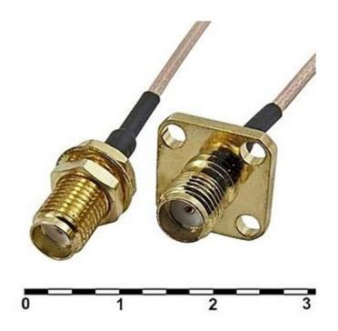
Шнур представляет из себя коаксиальный кабель длиной 30 сантиметров, заделанный с одной стороны гнездом SMA (Au) на панель, с другой стороны гнездом SMA (Au) с фланцем (4 отверстия) на панель.
