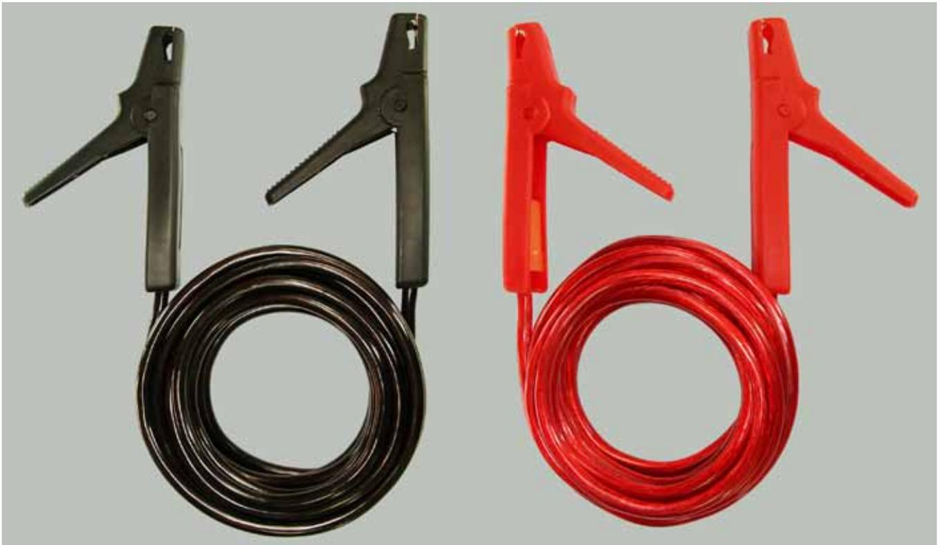
Стартовые провода (провода для «прикуривания») предназначены для запуска двигателя автомобиля с разряженной аккумуляторной батареей от аккумулятора другого автомобиля.
