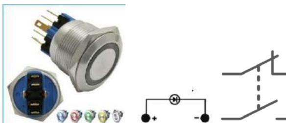
Кнопки антивандальные серий QGQZ22 предназначены для коммутации цепей питания, сигнализации, управления и т.п. с напряжением до 250 В и силой тока до 5 А. Кнопки применяются в местах с повышенными требованиями к прочности, износостойкости и классу защиты коммутационного оборудования: на предприятиях, в учреждениях, на объектах транспорта, в ЖКХ и т.п. Фиксация кнопок в местах эксплуатации осуществляется с помощью резьбового соединения с посадочным диаметром 22 мм (QGQZ22).
