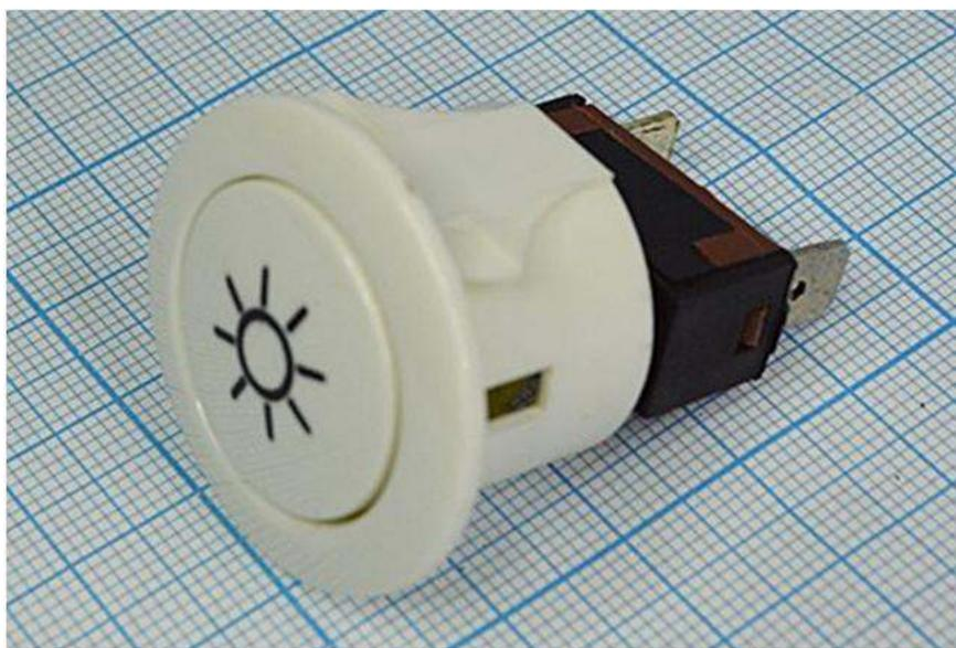
**Кнопка предназначена для коммутации электрических цепей с рабочим напряжением 250 вольт и током нагрузки до 10 ампер (16A\125VAC). Посадочный диаметр крепления кнопки на панель 24 мм.**
