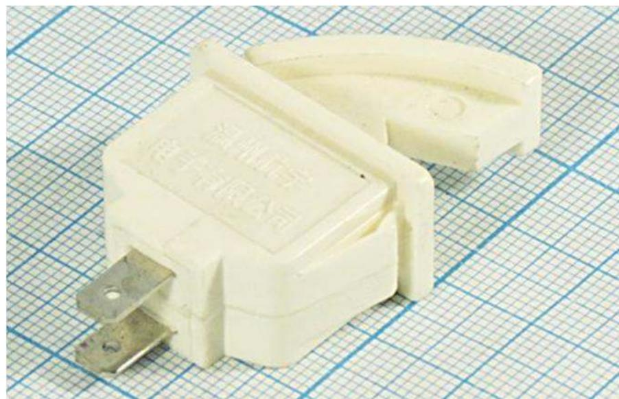
**Переключатель предназначен для коммутации электрических цепей с рабочим напряжением до 250 вольт и током нагрузки до 0,5 ампера. Основное применение находит в системах сигнализации, где необходимо отслеживать крайнее положение дверей, окон и других конструкций.**
