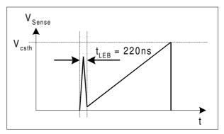
Figure 13 Leading Edge Blanking
