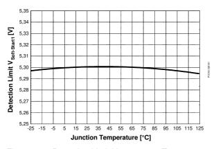
Figure 41 Detection Limit  $V_{Soft-Start1}$  vs.  $T_j$
