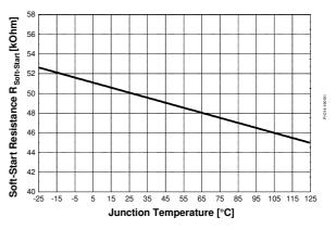
Figure 39 Soft-Start Resistance  $R_{Soft-Start}$  vs.  $T_j$
