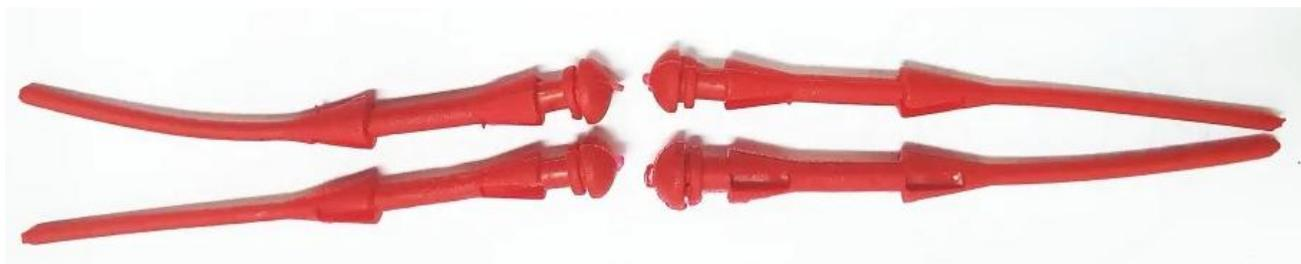
Антивибрационные винты (гвозди) применяются для крепления корпусных вентиляторов вместо обычных металлических винтов. Резина винтов эффективно поглощает вибрации вентилятора, изолируя его от корпуса компьютера. Предназначены для установки вентилятора с крепежными отверстиями 4мм.
