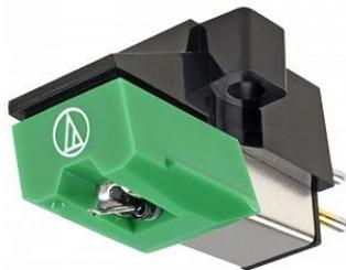
Audio-Technica AT-95E/AT95EBL - головка звукоснимателя MM типа. Частотный диапазон: 20 - 20000 Гц. Выходное напряжение: 3.5 мВ. Сопротивление нагрузки: 47 кОм. Прижимная сила: 1.5 - 2.5 г. Вес: 5.7 г.
