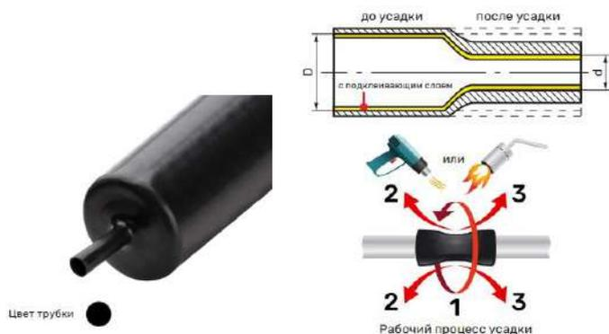
Трубка термоусаживаемая ТУТ с подклеивающим слоем с коэффициентом усадки 6:1 применяется при монтаже проводных и кабельных соединений.
