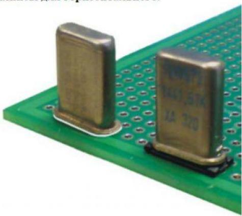
При вертикальном монтаже кварцевый резонатор должен быть установлен на плату через изолирующую прокладку максимально плотно для исключения разрушения стеклотаблетки в корпусе при ударах и вибрациях.
