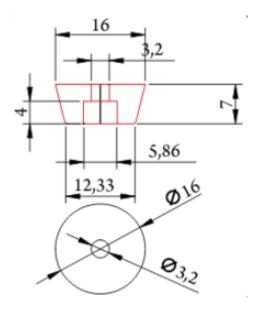
Диаметр: 16 мм Высота: 7 мм
