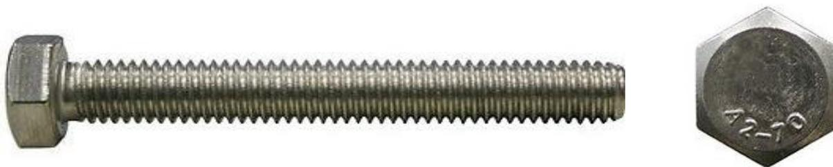
A2 – это сокращенное название марки нержавеющей аустенитных (Austenitic) сталей. Аустенитная сталь обладает рядом замечательных свойств, которые обеспечили ей очень широкое применение в народном хозяйстве. Сталь A2 не токсична, устойчива к коррозии. Она хорошо подвергается механической и термической обработке, а также сварке. Крепежные изделия, изготовленные из стали A2, практически не магнитны, прочны и долговечны. Они отлично сохраняют свои свойства при высоких и низких температурах.
