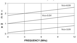
AT89C4051 TYPICAL ICC vs. VOLTAGE- POWER DOWN (85°C)
