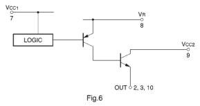
V<sub>OH</sub>=V<sub>R</sub>-V<sub>sat</sub> (PNP)-V<sub>BE</sub> (NPN)
