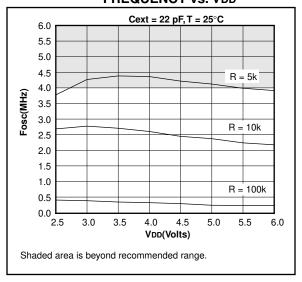
FIGURE 21-6: TYPICAL RC OSCILLATOR FREQUENCY vs. VDD
