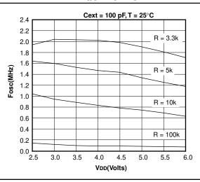
FIGURE 21-7: TYPICAL RC OSCILLATOR FREQUENCY vs. VDD
