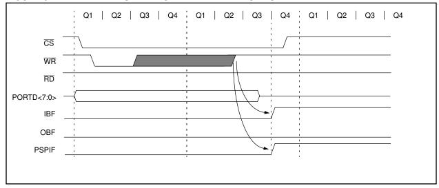
FIGURE 5-13: PARALLEL SLAVE PORT READ WAVEFORMS
