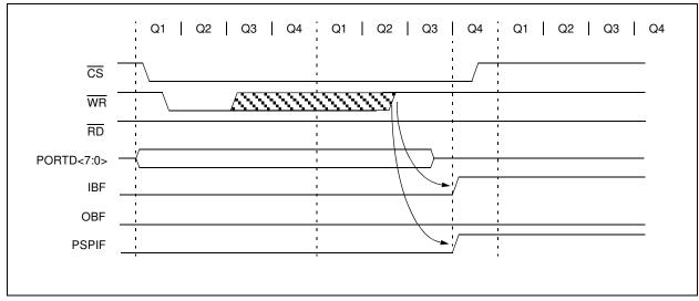
FIGURE 4-10: PARALLEL SLAVE PORT READ WAVEFORMS
