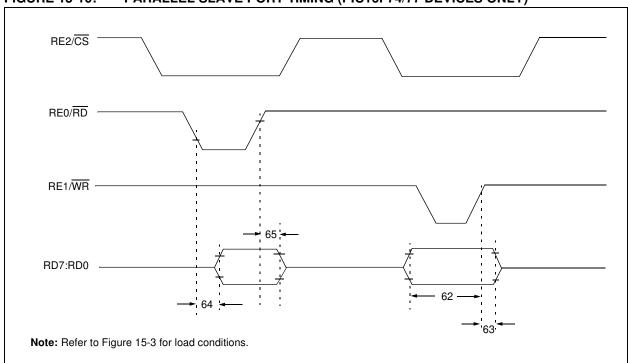
FIGURE 15-10: PARALLEL SLAVE PORT TIMING (PIC16F74/77 DEVICES ONLY)
