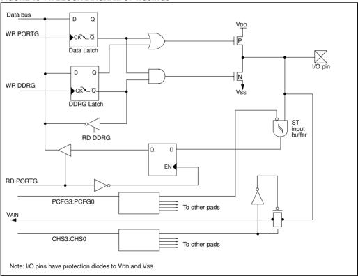
FIGURE 10-15: RG4 BLOCK DIAGRAM
