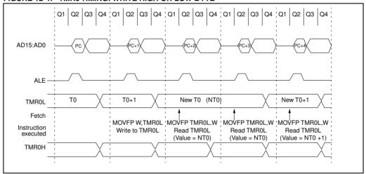
FIGURE 12-5: TMR0 READ/WRITE IN TIMER MODE
