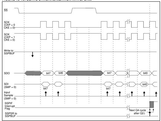
FIGURE 15-11: SPI MODE WAVEFORM (SLAVE MODE WITH CKE = 0)
