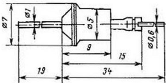
Стабилитрон KC456A кремниевый, диффузионно-сплавный, средней мощности.
