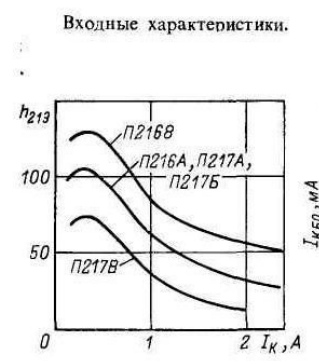
Зависимость статического коэффициента передачи тока от тока коллектора.
