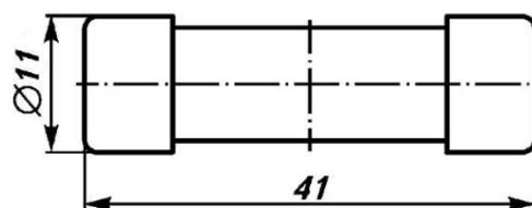
Предохранитель (вставка плавкая) ВТФ
