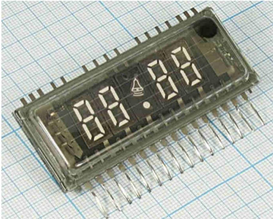
Знакосинтезирующие индикаторы ИЛЦ7-4/7Л вакуумные, люминесцентные многоразрядные, одноцветные. Предназначены для отображения звукового сигнала, информации о часах, минутах, секундах. Режим управления мультиплексный. Оформление стеклянное, плоское, с выводами (16 шт.), расположенными с одной стороны баллона. Рабочее положение горизонтальное. Масса индикатора 40 г.
