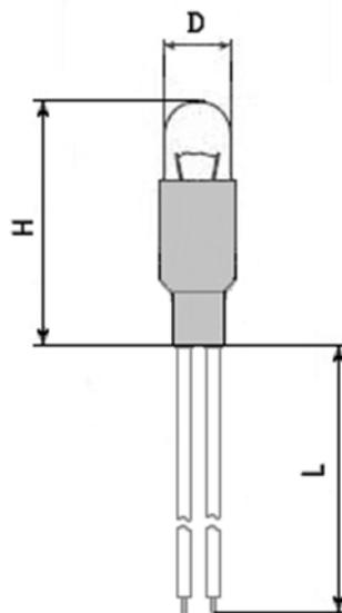
**Рабочее напряжение 12 v, потребляемый ток 50 mA**
