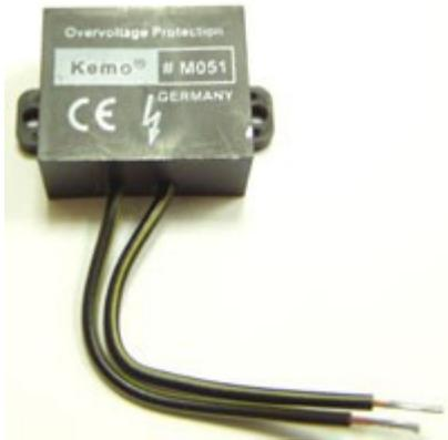
Блок защиты - грозовой разрядник предназначен для защиты бытовой электроаппаратуры от высоковольтных импульсов, возникающих в сети переменного напряжения 220 В во время сильных грозовых разрядов. Блок подсоединяется параллельно цепям питания электроприборов и позволяет снизить высоковольтные импульсы до ~325 В. С помощью этого простого устройства вы сможете сэкономить время и деньги на ремонт или покупку новой аппаратуры. Модуль имеет корпус и не требует сборки. Размеры модуля 25x22x17 мм.
